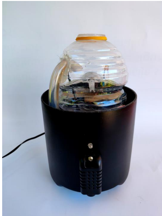
Slika 22. Spremnik s vodom u kućištu
