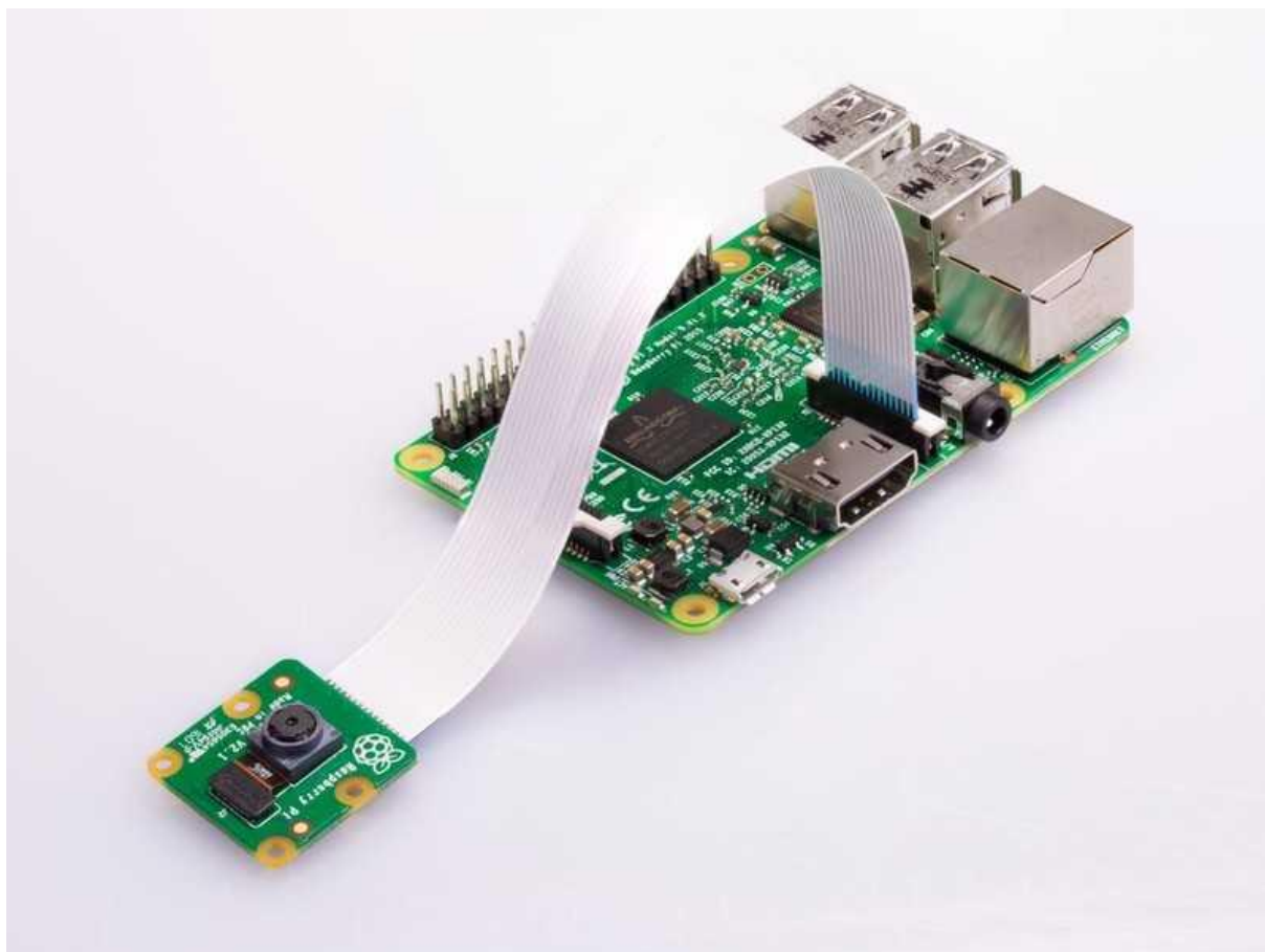
Slika 28 Pi Camera Module v2 spojen na odgovarajući konektor na Raspberry Piju
