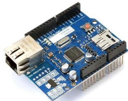
**Slika 4: Izgled Ethernet Shielda**
