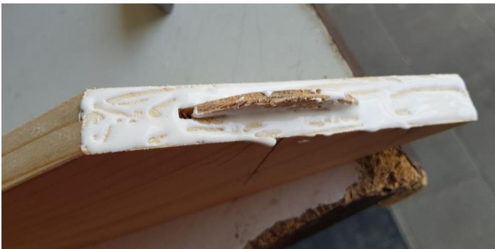
**Slika 3.2 Drveni vezni element korišten za povezivanje dijelova okvira**
