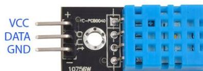
Slika 4: Senzor temperature i vlažnosti DHT11
